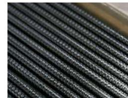
05. 次にその最外層に4軸組布を巻き付け、捻じれに強くします。
