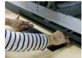
03. その圧着されたプリプレグを芯棒に巻き付けます。この巻付けは、カーボンシートが撥ねないよう専用の機械で行ないます。
