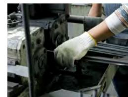
08. 数回に分けて $1/100$ ミリ単位で研磨して、シャフトとして完成させます。
