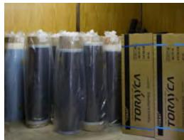
01. カーボンプリプレグ(炭素繊維に樹脂を含浸させたシート状のものは)は常温でも硬化が始まるため、冷蔵室・冷凍庫に保管されています。
