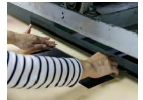
03. その圧着されたプリプレグを芯棒に巻き付けます。この巻付けは、カーボンシートが撥ねないように専用の機械で行ないます。
