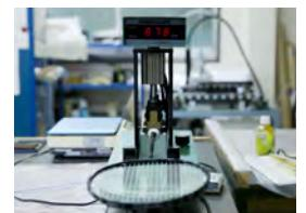
09. 最終製品となった後、特性を十分に活かせているか、完成したラケットの状態でも、シャフトの剛性を振動計でチェックします。
