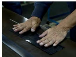
04. 繊維方向が $0^{\circ}$ のカーボンに関してはその上に、カーボン繊維が直線に配されたシートを手で、擦れないように丁寧に巻き付けます。
